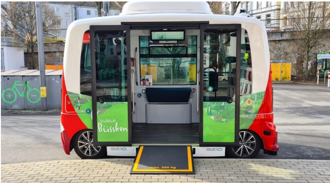
Abbildung 5: Fahrzeugansicht mit ausgefahrener rollstuhlgerechten Rampe.
