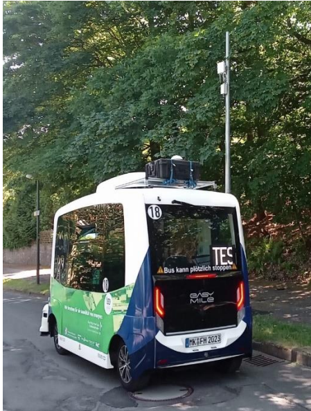
Abbildung 18: a-BUS mit montierter Funk-Dachbox zur Einbindung in das Kommunikationssystem (links) sowie Blockschaltbild der Dachbox (rechts).
