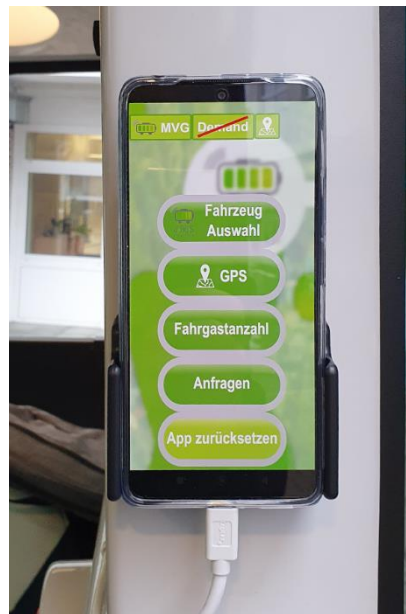
Abbildung 25: Montage des Operator-Smartphones im Türbereich eines Busses für die Freihandbedienung.
