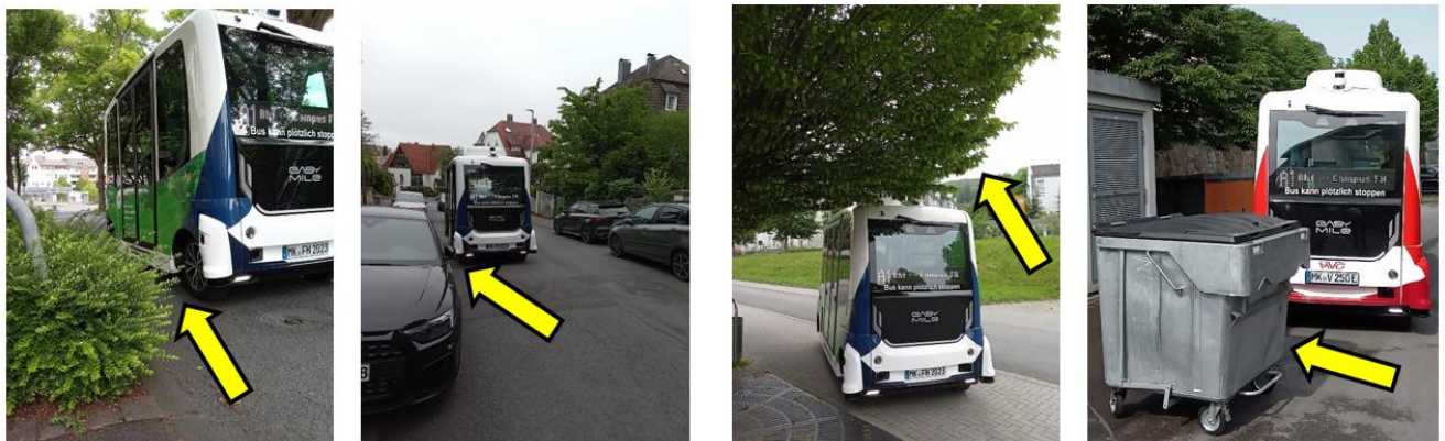
Abbildung 6: Beispiele für Fahrsituationen die einen ungeplanten Fahrzeugstopp verursachen.
