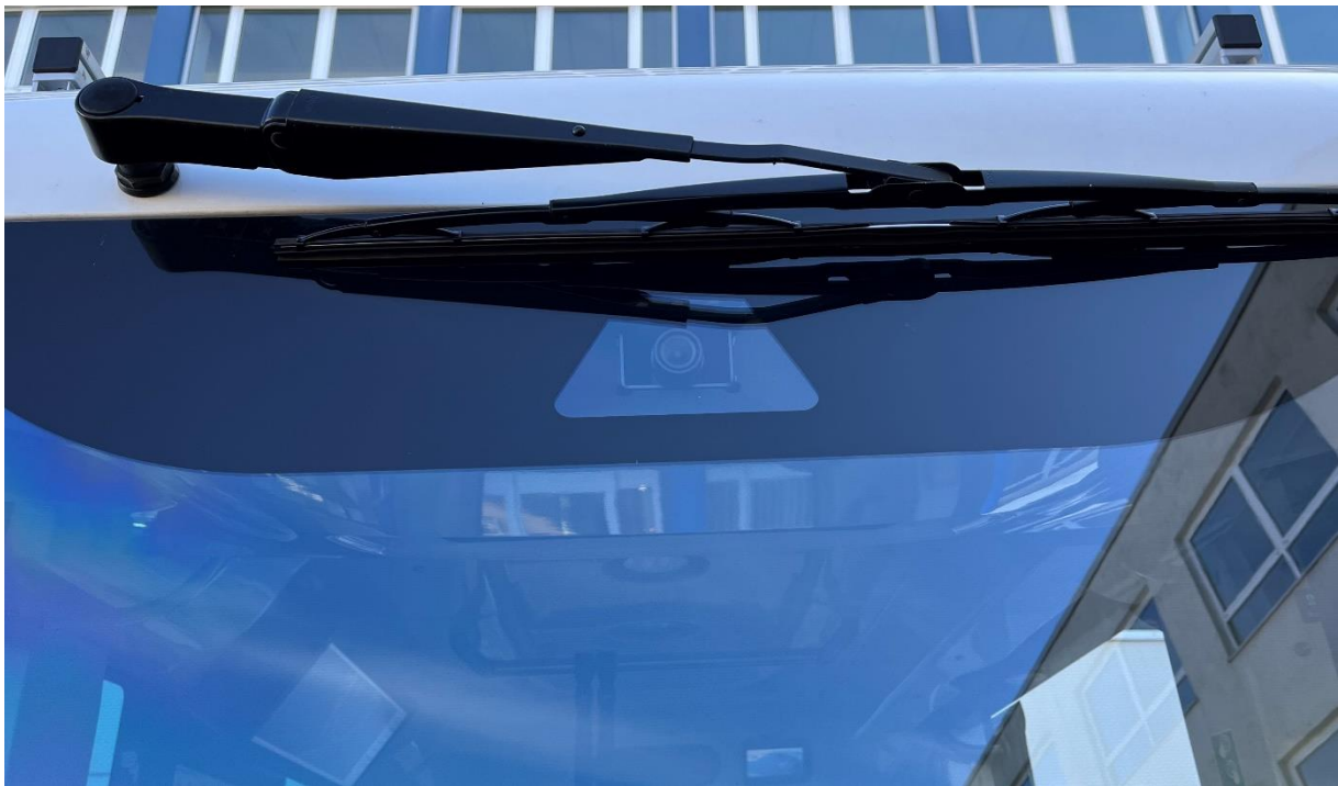
Abbildung 21: Kamera zur Überwachung der Fahrzeugumgebung.
